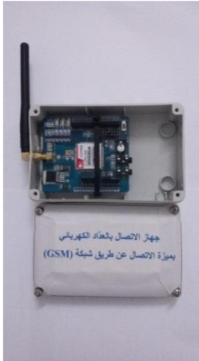
شكل 7. الجهاز المستخدم في عملية الاتصال بالعداد عند منظومة التحكم
