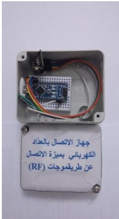
شكل 4. الجهاز المستخدم في عملية الاتصال بالعداد عند القارئ
