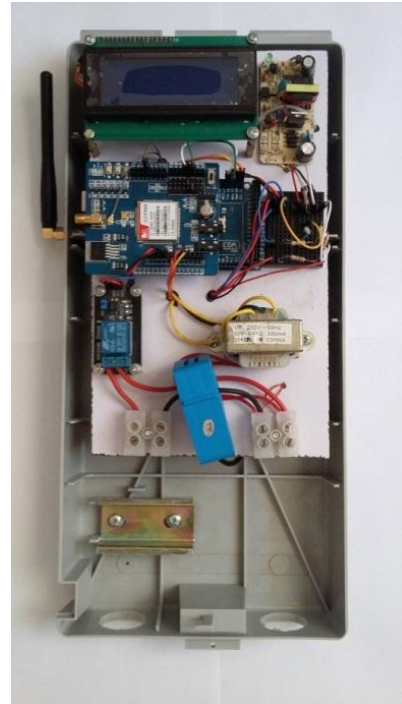
شكل 6. العداد الكهربائي المصمم بميزة الاتصال عن طريق موجات (GSM)
